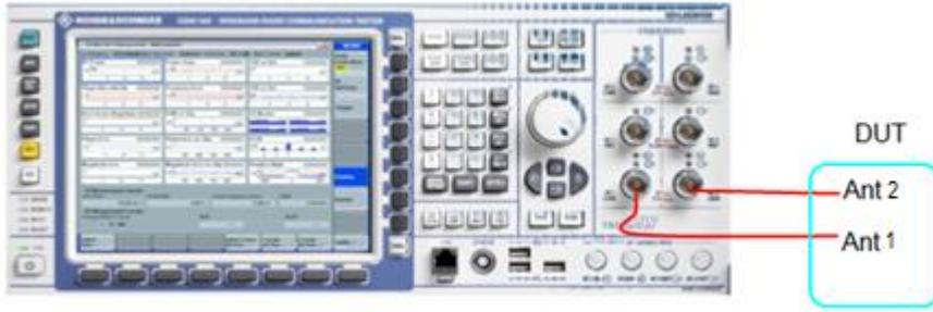
c: 主辅载波独立天线设计的连接示意图
