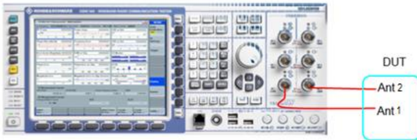
c: デュアル・アンテナ搭載の CA 対応 DUT と CMW500 との接続例
