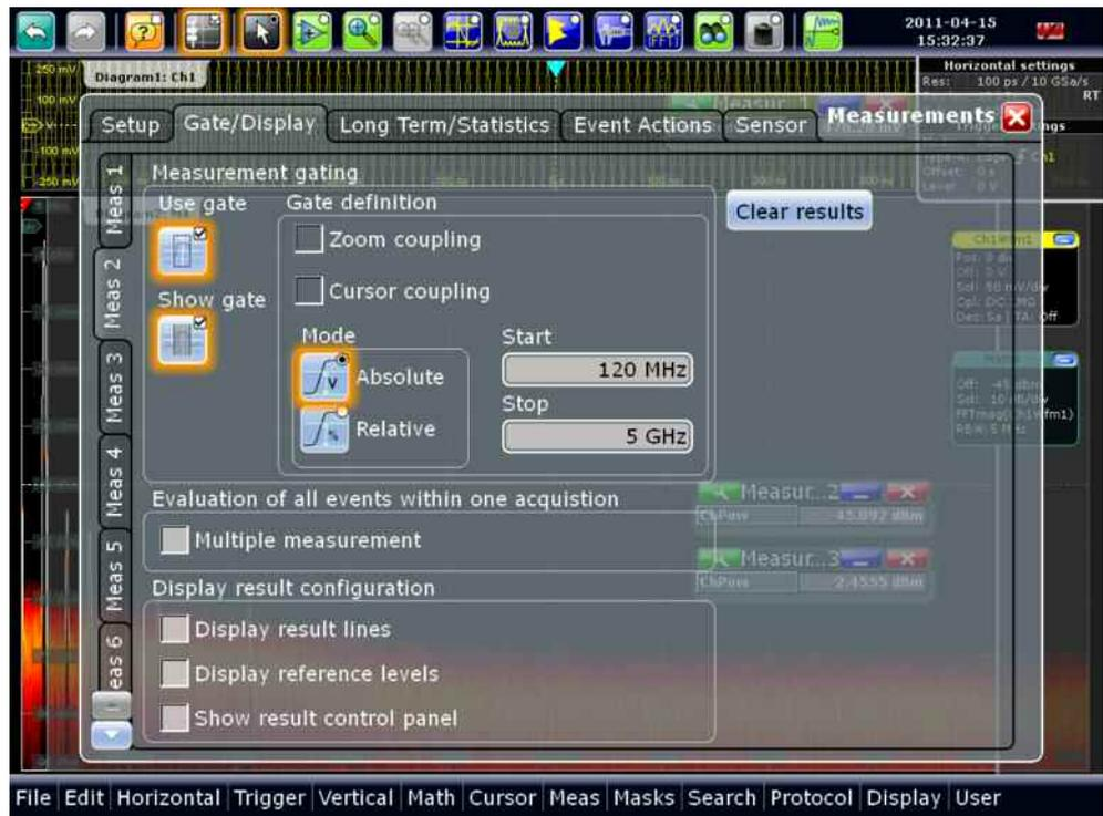
図 11: ノイズおよび歪パワーのゲート測定 (Measurement 2) のセットアップ・スクリーン情報
