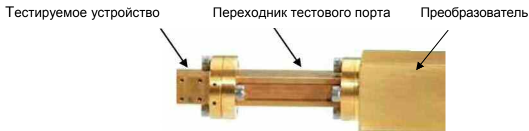
Рис. 2.2: Рекомендуемая конфигурация для подключения ТУ к преобразователю
