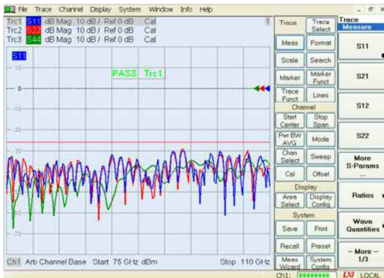
Рис. 4.10 Автоматическая проверка соответствия возвратных потерь всех портов направленного ответвителя заданным граничным условиям
