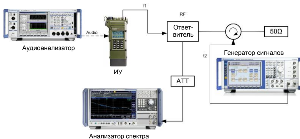
Рис. 6 – Схема для измерения интермодуляции передатчиков.
