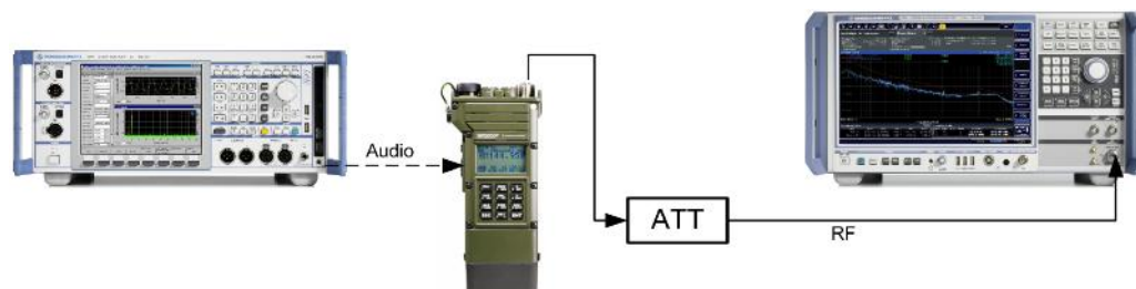
Рис. 14 – Базовая установка для испытаний передатчика. Анализатор измеряет передаваемый радиосигнал через аттенюатор. Входным сигналом может служить, например, аудиосигнал из аудиогенератора UPV.
