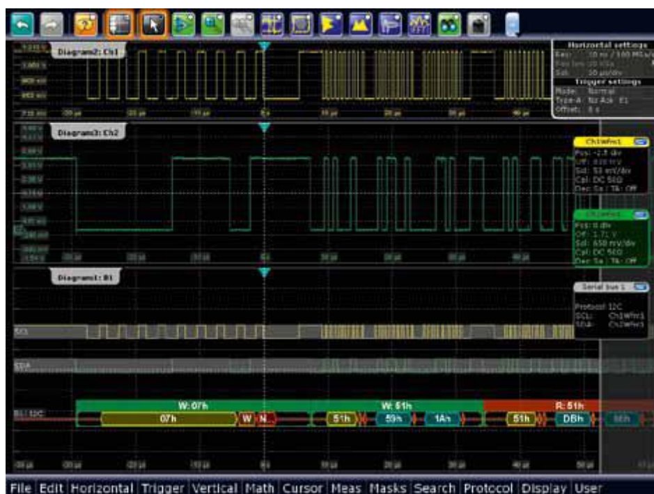
Рис. 37 – Пример логического анализа: высокая частота дискретизации позволяет быстро обнаруживать ошибки в протоколе передачи данных.
