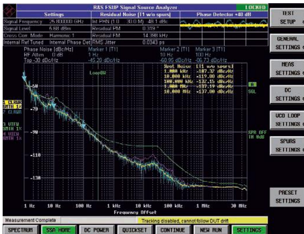
Рис. 29 – Измерение фазового шума с помощью анализатора FSUP.
