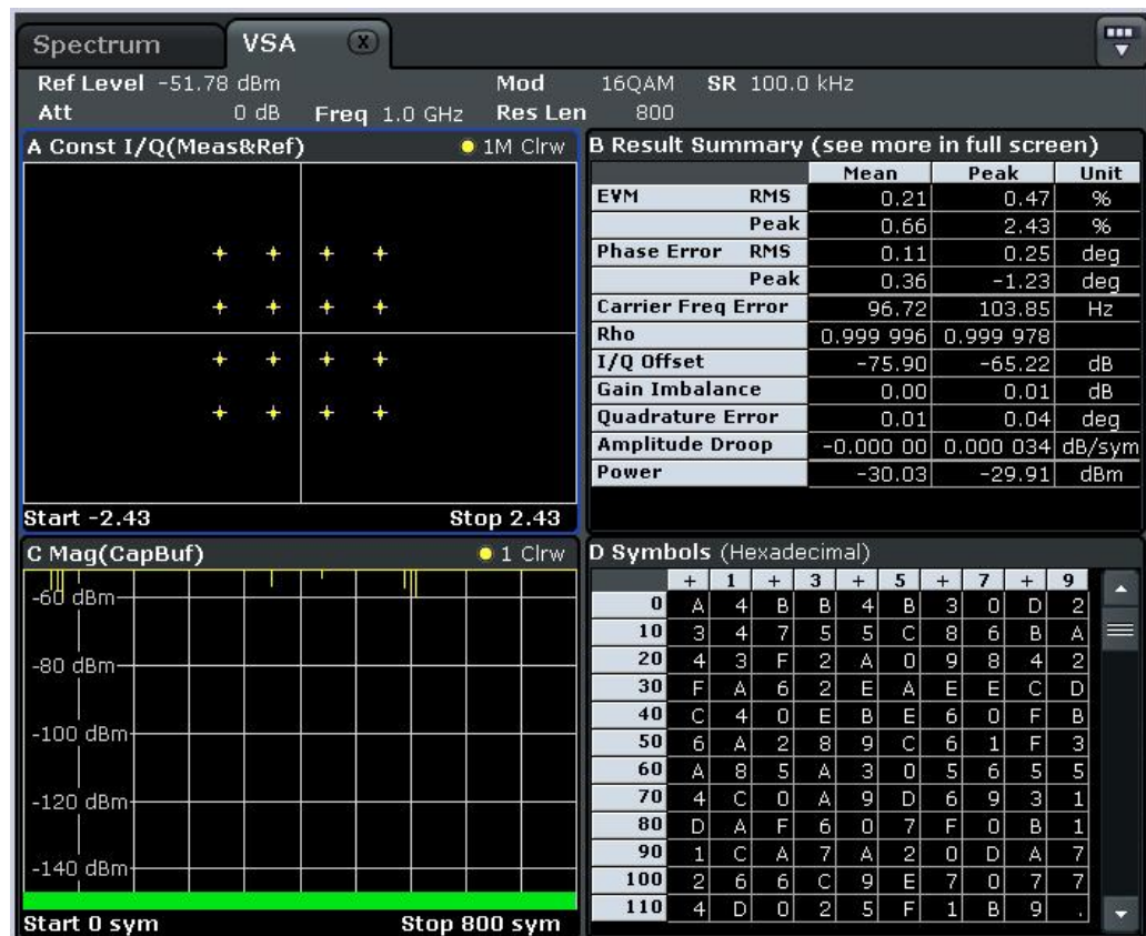
Bild 18: Beispiel für die Analyse eines 16QAM-Signals mit der K70. Das Bild zeigt das Konstellationsdiagramm, eine Übersicht der wichtigsten Ergebnisse sowie den Symbol-(Bit-)stream.
