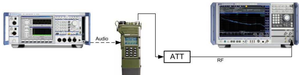
Bild 14: Prinzipieller Aufbau des Sender-Tests. Der Analysator misst das TX-Signal des Funkgeräts über ein Dämpfungsglied. Als Eingangssignal kann z.B. ein Audio-Signal aus dem Audio-Generator des UPV benutzt werden.
