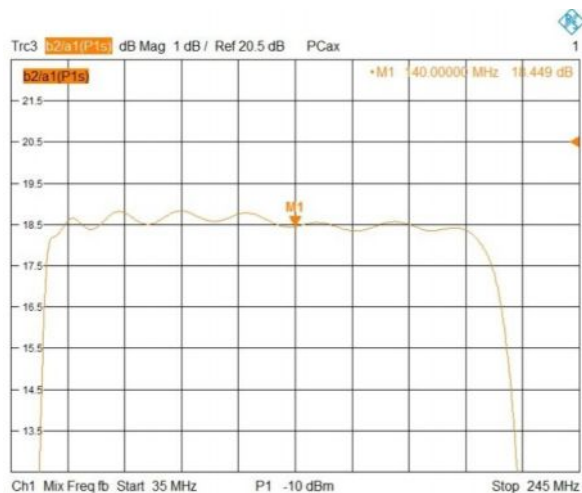
Рисунок 4-23 – Коэффициент преобразования испытуемого преобразователя с ПЧ 140 МГц
