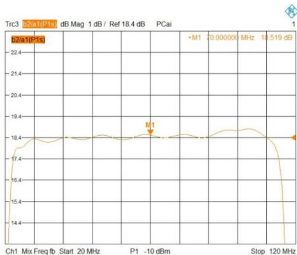
Рисунок 4-22 – Коэффициент преобразования испытуемого преобразователя с ПЧ 70 МГц
