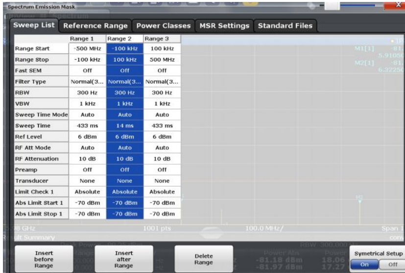
Рисунок 4-41 – Список разверток для спектральной маски излучения для побочного излучения, не зависящего от сигнала, в соответствии с техническими требованиями преобразователя
