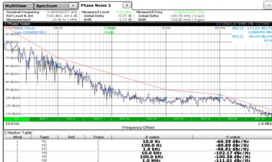
Рисунок 4-36 – График фазового шума, измеренного прибором FSW на выходе испытуемого преобразователя на ПЧ 70 МГц
