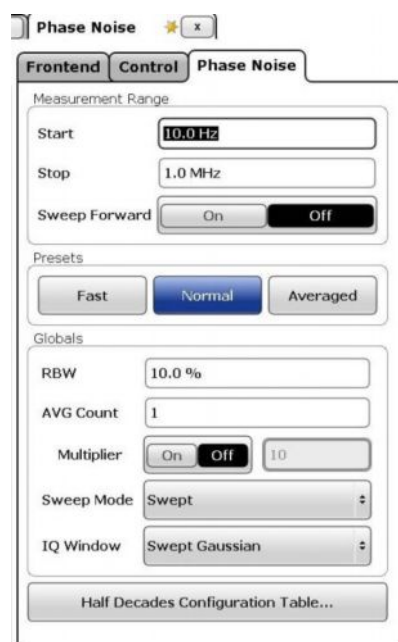
Рисунок 4-35 – Настройки для проведения измерений характеристик фазового шума
