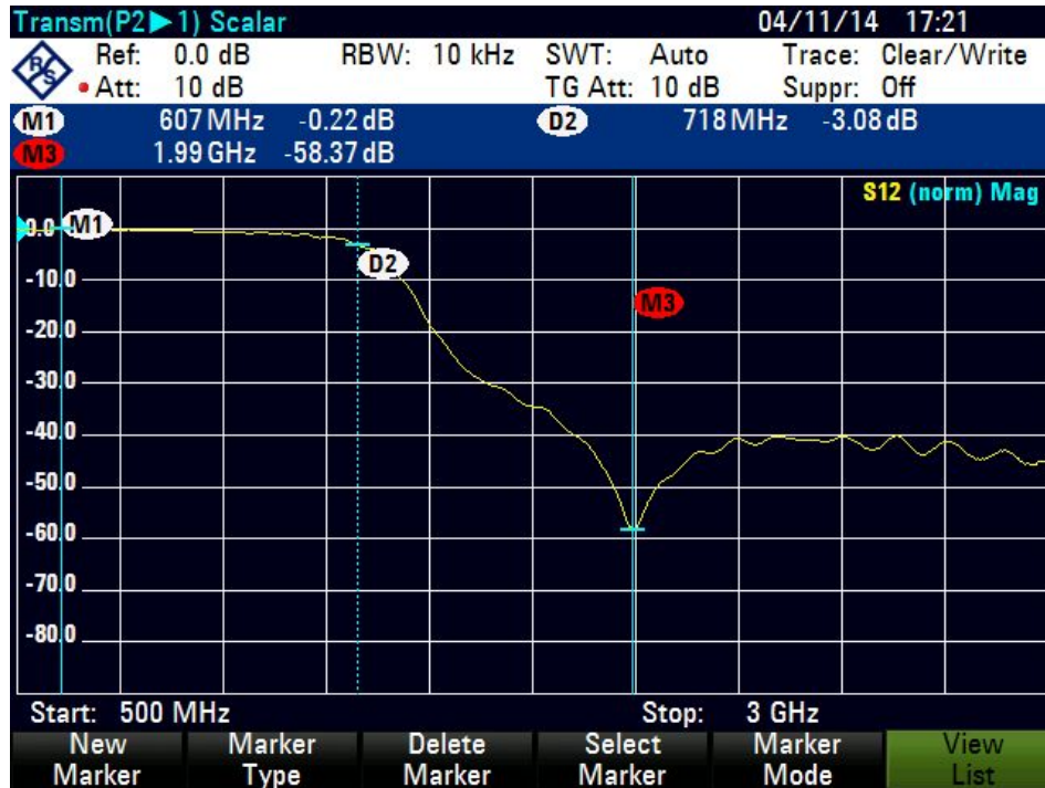
Рис. 2-17 – Измерение частоты среза по уровню -3 дБ и максимального ослабления в полосе задерживания для ФНЧ
