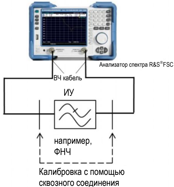
Рис. 2-16 – Измерение характеристик фильтра с помощью анализатора спектра FSC со встроенным следящим генератором
