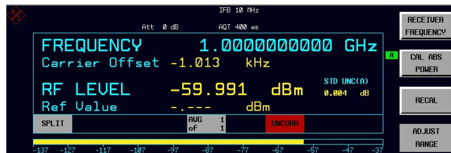
Abbildung 2: Ausschnitt aus dem FSMR-Display mit dem Warnhinweis UNCORR , dass der zulässige Bereich der Rekalibrierung verlassen wurde
