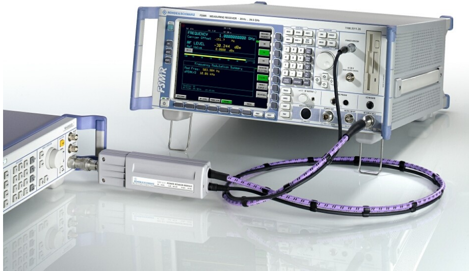
Abbildung 13: Messaufbau mit Power Sensor Module NRP-Z27
