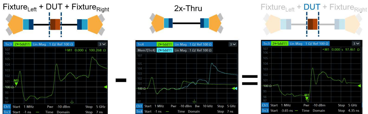
図 12 - インピーダンス補正なしの従来のディエンベディング：左の図には、構造全体のインピーダンスプロファイルが表示されています。これには、リードインの 98 Ω インピーダンスプロファイルと、リードアウトの 102 Ω インピーダンスプロファイルだけでなく、中央のインラインコネクタも含まれています。左のフィクスチャのモデル (中央の図：緑色トレース) は、2x スルーケーブルから直接作成されるもので、100 Ω インピーダンスプロファイル (中央の図：青色トレース) に一致しています。リードインは正しくモデリングされませんが、リードアウトも同様です。右の図では、ディエンベディング結果にファントムリムが残っています。リードインとリードアウトが適切に除去されていないことがわかります。
