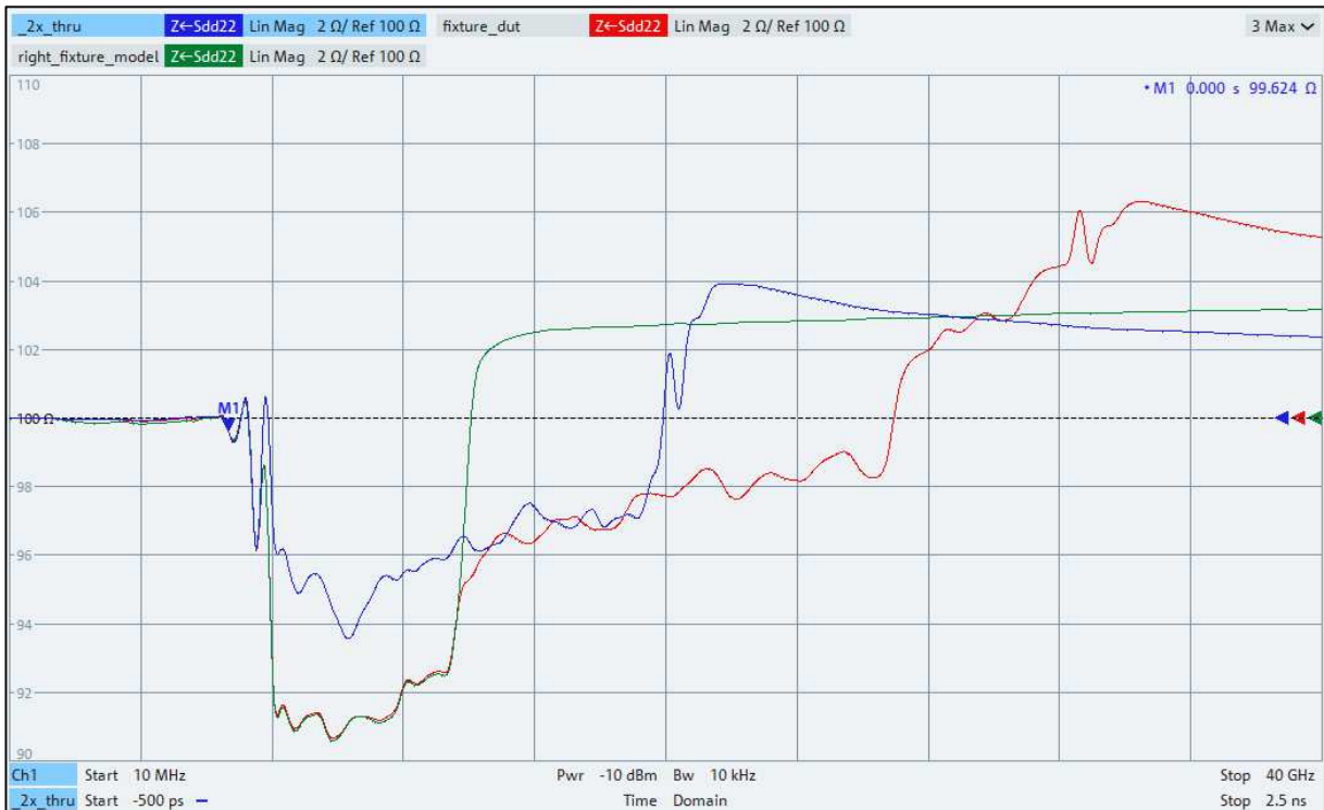
図 20 - R&S®ZNA43 によるインピーダンス補正ありのディエンベディング：整合性チェック。導かれた右側のフィクスチャモデル（緑色トレース）と、反転「フィクスチャ-DUT2B-フィクスチャ」構造（赤色トレース）および反転 2x スルー（青色トレース）を比較します。
