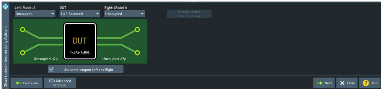
図 9 - 「フィクスチャ-DUT-フィクスチャ」構造のトポロジー構成。
