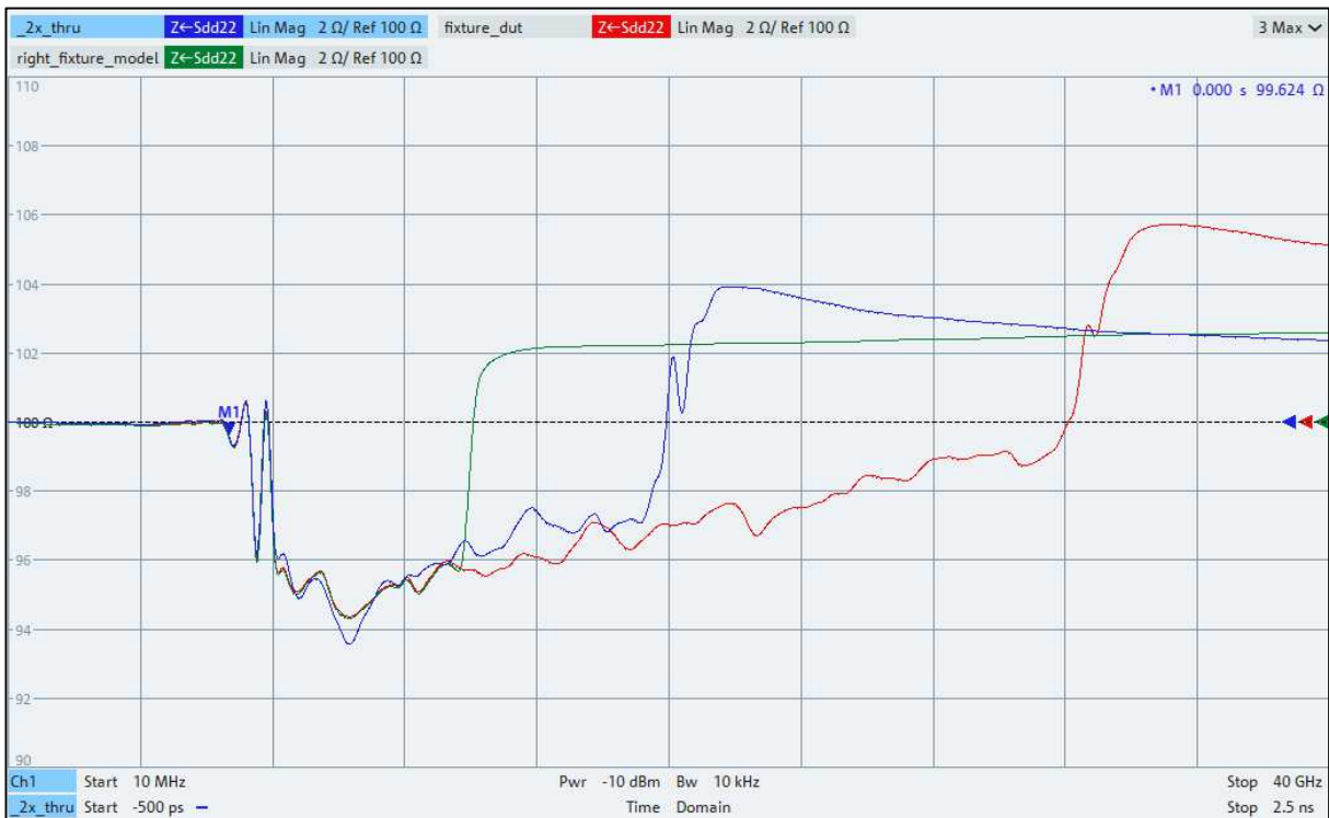
図 18 - R&S®ZNA43 によるインピーダンス補正ありのディエンベディング：整合性チェック。導かれた右側のフィクスチャモデル（緑色トレース）と、反転「フィクスチャ-DUT 2A-フィクスチャ」構造（赤色トレース）および反転 2x スルー（青色トレース）を比較します。
