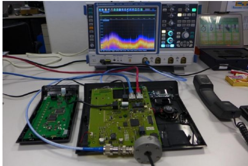
Рис. 4-13 – Ток РЧП, измеренный в кабеле телефонной трубки.
