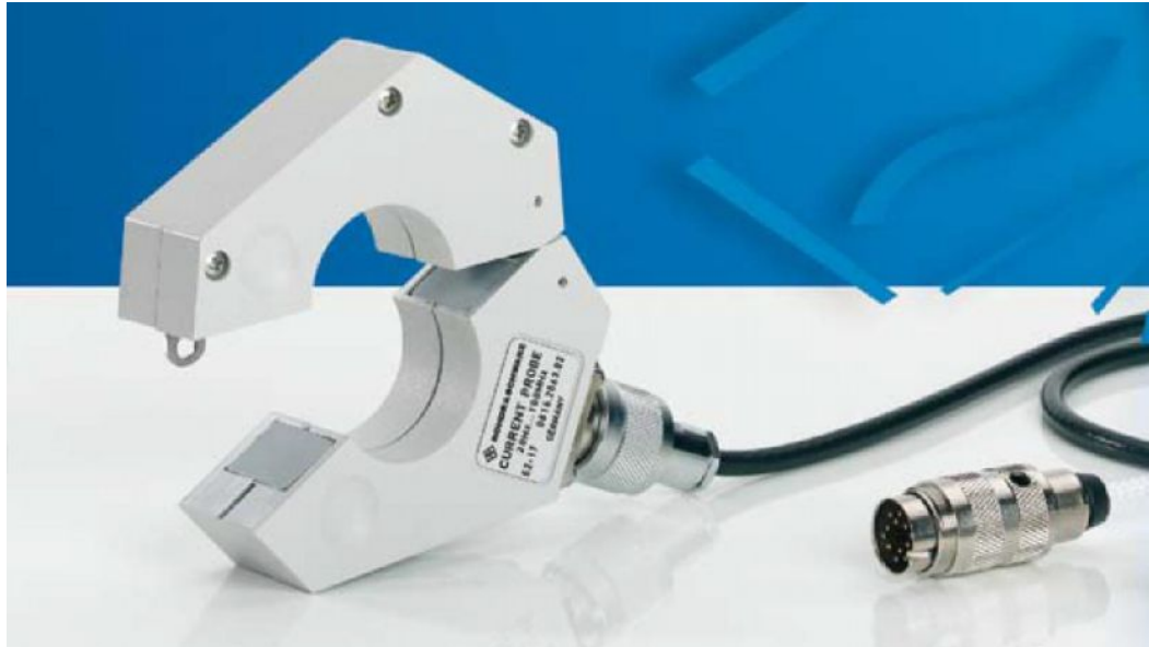
Рис. 3-3 – Токовый пробник R&S®EZ-17 с передаточным импедансом 10 дБом (модель 02) или 17 дБом (модель 03) и полосой пропускания от 20 Гц до 100 МГц является хорошим примером устройства, подходящего для измерений тока РЧП. Большой внутренний диаметр в 30 мм позволяет измерять кабельные бухты.
