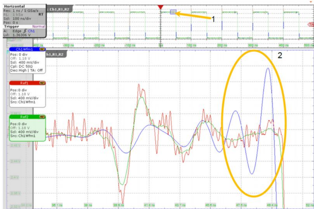
Рисунок 3-3 – Сравнение методов снижения уровня шума (зеленая: HD-режим; синяя: режим "High res"; красная: исходная осциллограмма)
