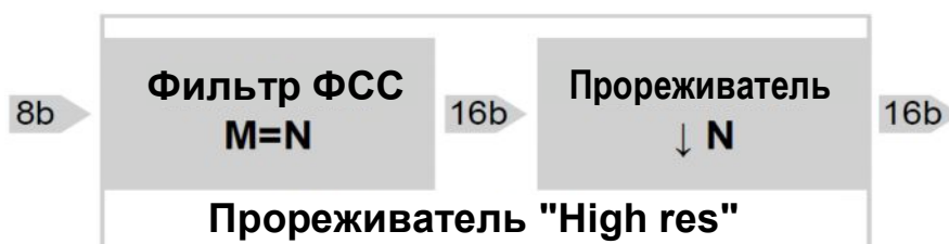
Рисунок 3-1 – Функциональные блоки прореживателя "High res"
