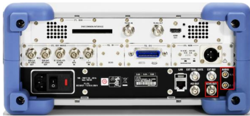
Abb. 10: Am R&S®ETL stehen zwei Ausgänge zur weitergehenden Audioanalyse zur Verfügung
