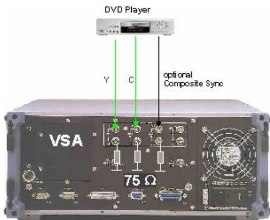
Bild 12 Der Meßaufbau für die Messungen fan DVD Spielern im S-VHS Format mit R&S VSA
