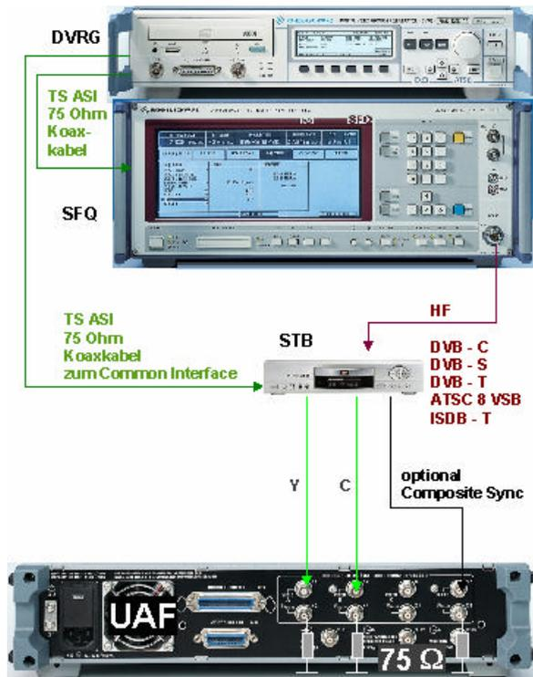
Bild 10 Der Meßaufbau für die zweite Meßmöglichkeit im S-VHS Format mit R&S UAF
