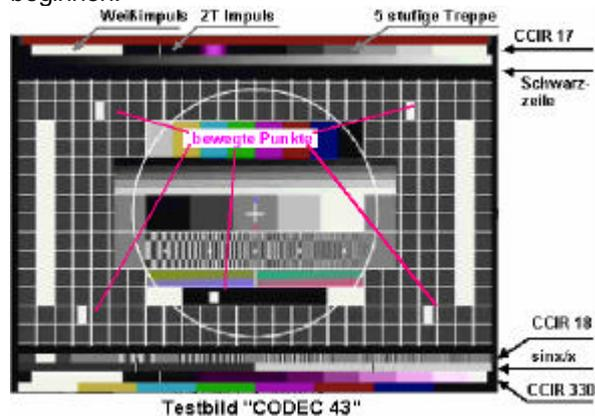
Bild 17 Das Testbild CODEC 43 mit seinen Signalelementen
