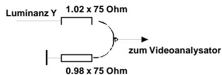
Bild 6 Luminanzverfälschung durch nicht korrekte Quellwiderstände bzw. Rückflußdämpfung
