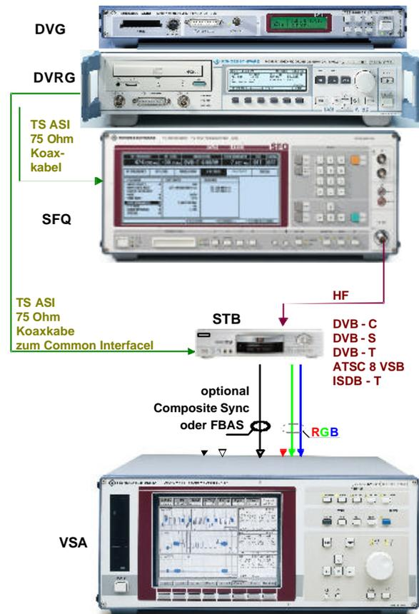
Bild 13 Der Meßaufbau für die Messungen fan STBs im RGB Format mit R&S VSA
