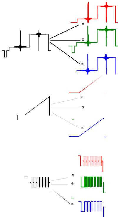
Bild 2 Die RGB Zerlegung der Signale  $\sin x/x$ , Sägezahn und Multiburst
