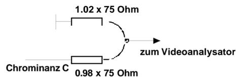
Bild 7 Chrominanzverfälschung durch nicht korrekte Quellwiderstände bzw. Rückflußdämpfung
