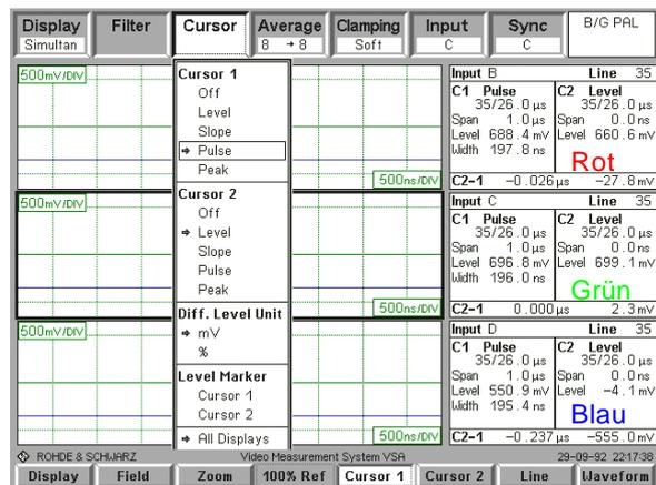
Bild 21 Cursoreinstellung zur Messung des Zeitversatzes R - G und G - B
