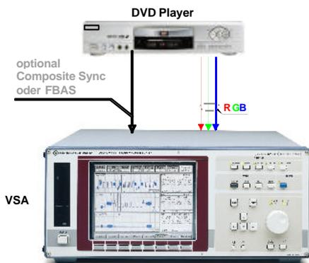
Bild 14 Der Meßaufbau für die Messungen an DVD Spielern im RGB Format mit R&S VSA
