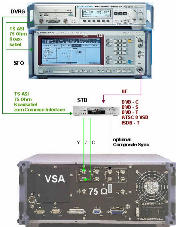
Bild 8 Der Meßaufbau für die erste Meßmöglichkeit im S-VHS Format mit R&S VSA
