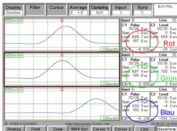
Bild 22 Messung des Zeitversatzes
