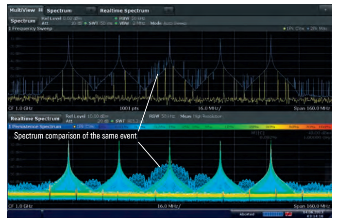
圖一、R&S®FSW 的連續頻譜顯示 (下方視窗) 可快速顯示中心頻率下的頻譜差異，即使是在難以察覺的掃頻顯示下 (上方視窗) 亦可顯示最大值鎖定的追蹤軌跡。
