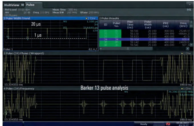
圖三、R&S®FSW-K6 脈衝量測選項，寬頻脈衝可以被隔離且完整的進行分析。
