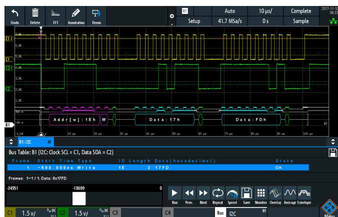
R&S®RTM3000 上的已解码 I 2 C 信号和模拟波形。
