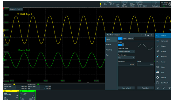
将注入的电源路径干扰调整为10 mV RMS。在R&S®RTO-B6波形发生器的输出使用20 dB衰减器以提高分辨率。
