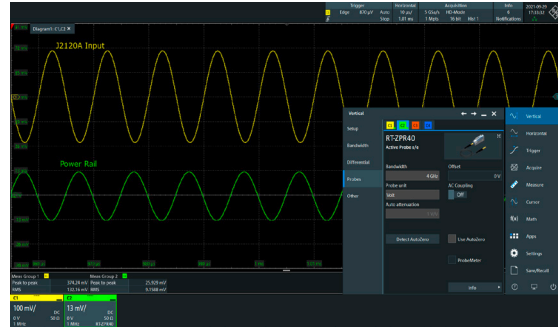
自动检测R&S®RTO6示波器的R&S®RT-ZPR20电源完整性探头。
