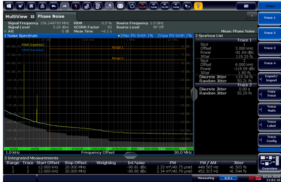
156.25 MHz振荡器的PSNR测量：示例，起始注入频率为3 kHz。
