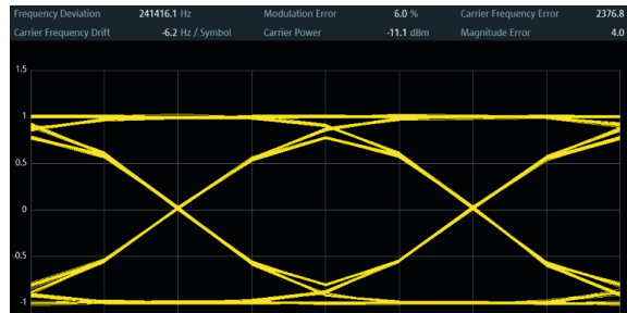
Fig. 3 BLE eye diagram measured at the BLE DUT.
