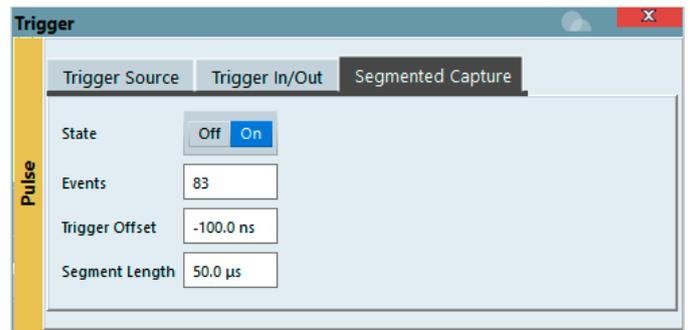
然后，配置显示。点击脉冲幅度显示，然后配置结果范围，确保将参考点和结果范围均配置为“rise”（上升），长度（即分段长度）配置为50 μs。
