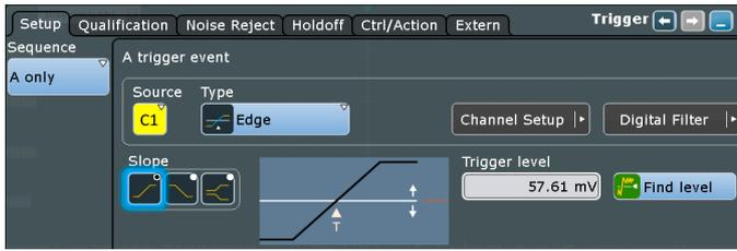
为边沿触发添加一个略长于受干扰雷达脉冲的触发抑制。本例中受干扰雷达的脉冲宽度为10 μs。
