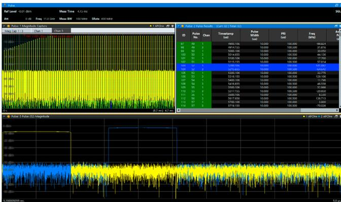
可以将数据导出到电子表格，并运行Visual Basic子程序来计算通道1和通道3中脉冲之间的时间戳或脉冲幅度差，进而自动进行RGPO测量。
