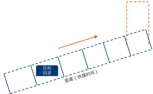
干扰机增加覆盖脉冲延时以将雷达拖到较晚的距离门，J/S变得无穷大。
