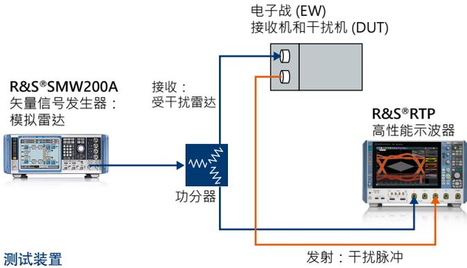
示波器是用于双通道比较测量的理想接收机，也是进行定时测量的黄金标准。测试装置包括R&S®SMW200A矢量信号发生器，用来模拟受干扰雷达并在干扰机中引起干扰响应，以及R&S®RTP高性能示波器，用来测量并比较受干扰雷达和干扰响应。测量可借助示波器和运行R&S®VSE-K6A相控阵测量选件的R&S®VSE矢量信号分析软件。
