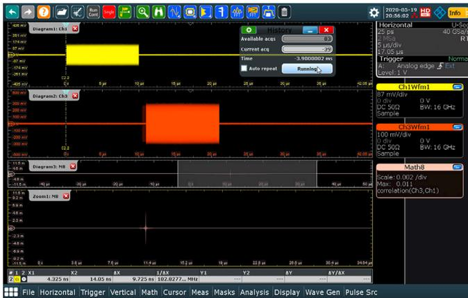
R&S®VSE矢量信号分析软件和R&S®VSE-K6A相控阵测量选件还可以测量射频脉冲。软件和选件内置包含脉冲宽度、脉冲幅度、脉冲重复间隔和脉冲频率的脉冲测量功能，这些功能难以使用示波器的基本功能直接测量。同时测量两个射频通道时（例如测量RGPO），R&S®VSE-K6A选件便于电子战 (EW) 工程师自动测量干扰技术并精确掌握相对定时和幅度情况。
