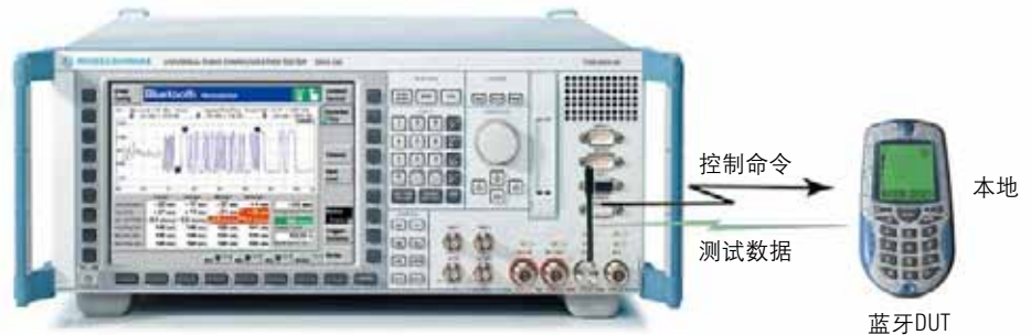
DUT可以通过射频耦合器或者电缆连接至R&S®CMU200。
