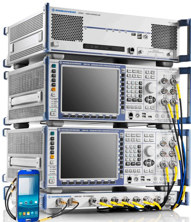
Le testeur de protocole R&S®CMW500 intégré à une plateforme R&S®CMWflex ; un environnement à CMW multiples fournissant une prise en charge fréquentielle jusqu'à 6 GHz pour des technologies telles que LTE-U, LTE-LAA et inter-réseaux WLAN/3GPP.
