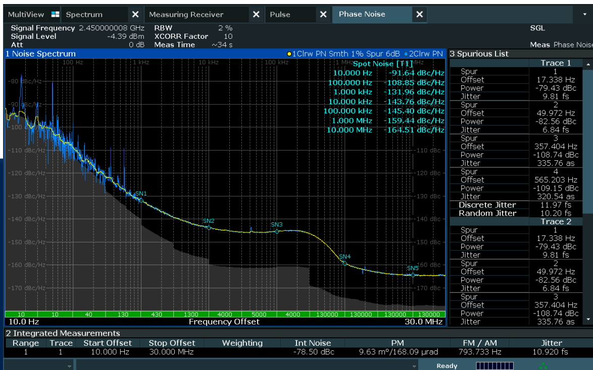
R&S®FSMR3-B60オプションによる振幅および位相雑音の測定。
