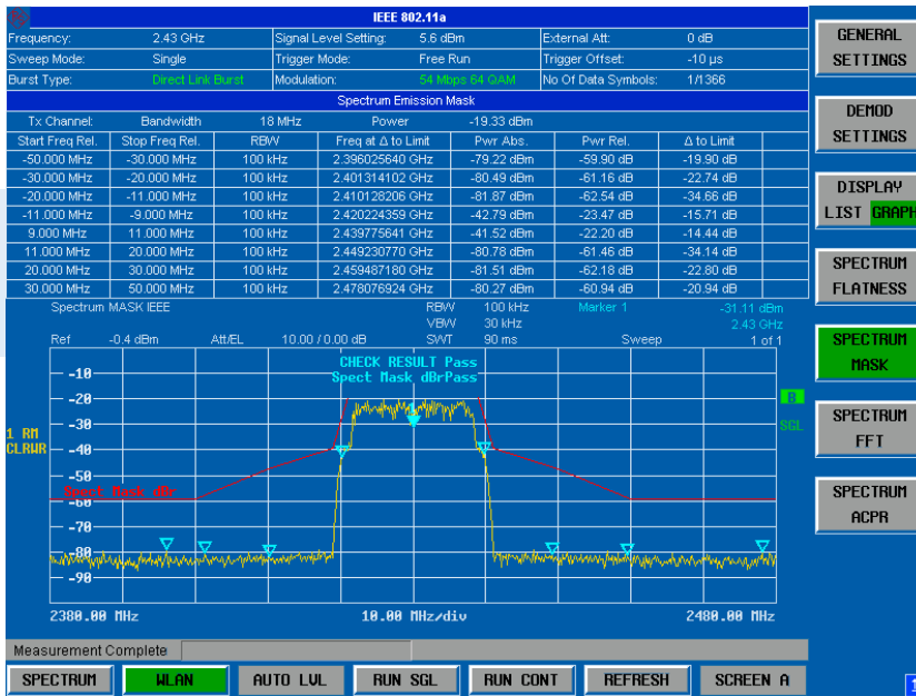
Bild 1a: Spektrumsmaske mit normkonformen Grenzwertlinien
