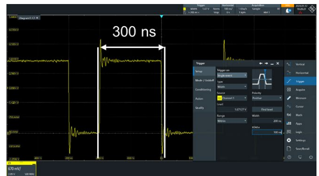
図 10 パルス幅トリガの測定例
