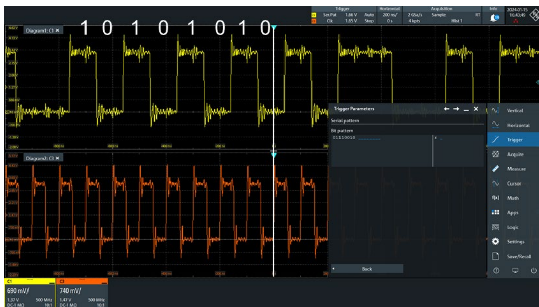
図 20 シリアルパターントリガの測定例
