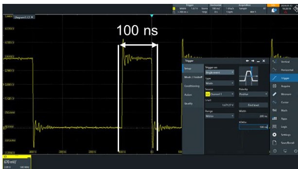
図 10 パルス幅トリガの測定例
