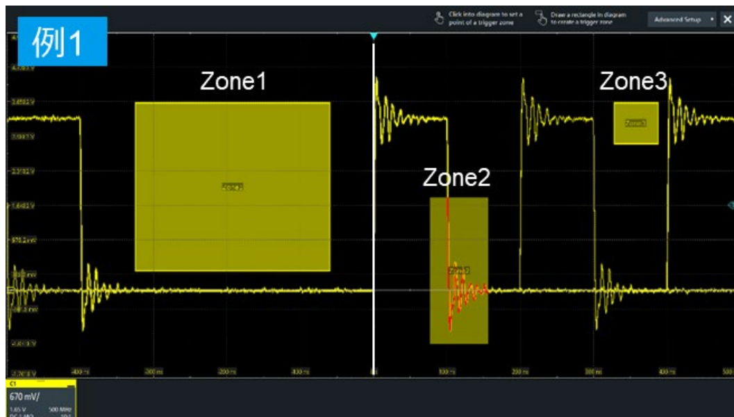
図 22 ゾーントリガの測定例 1
