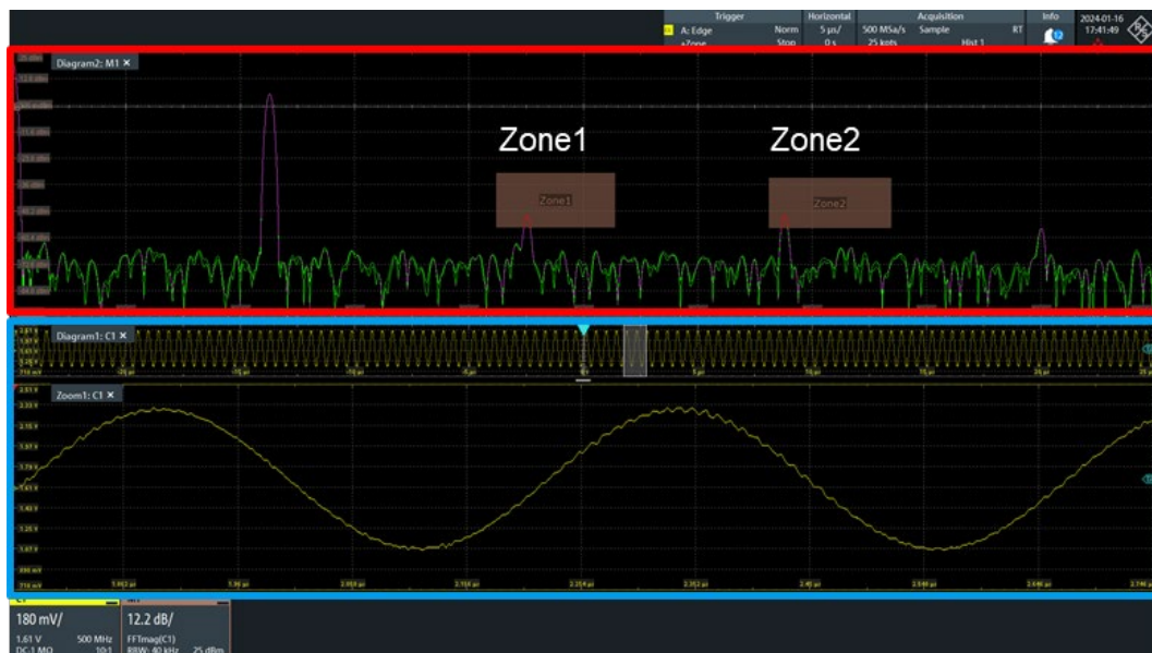
図 24 ゾーントリガの測定例（演算波形 FFT）
