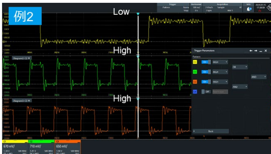
図 17 パターントリガの測定例 2
