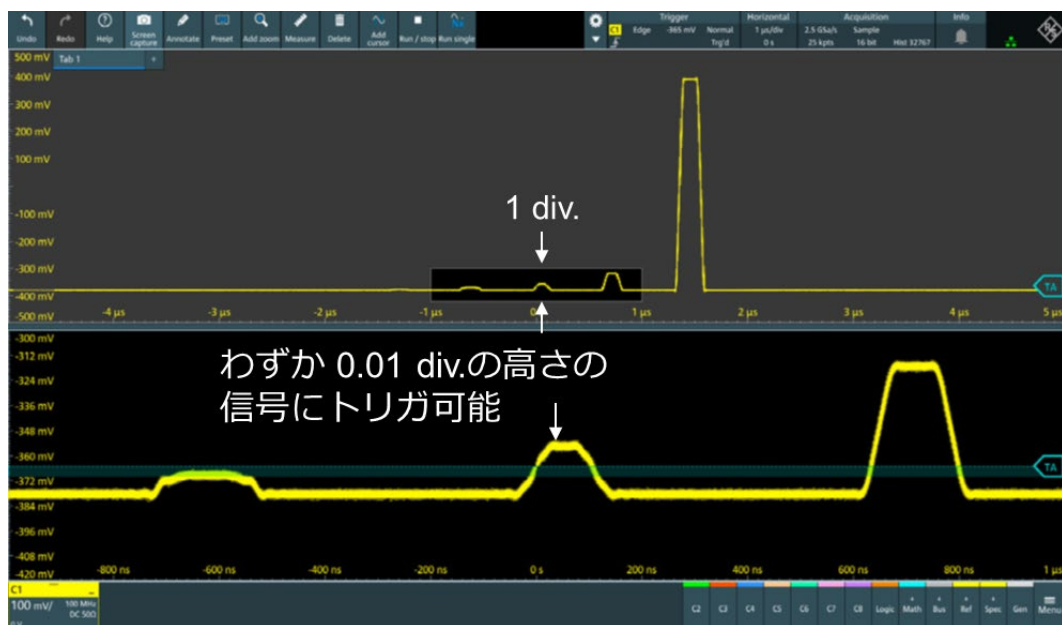
図6 デジタルトリガによる測定例
