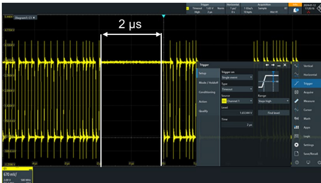
図 14 タイムアウトトリガの測定例
