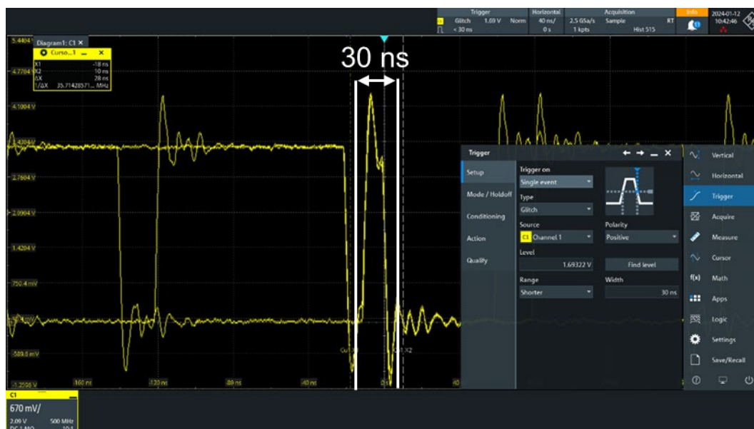
図 8 グリッチトリガによる測定例
