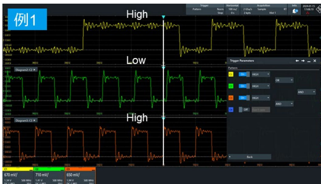
図 16 パターントリガの測定例 1
