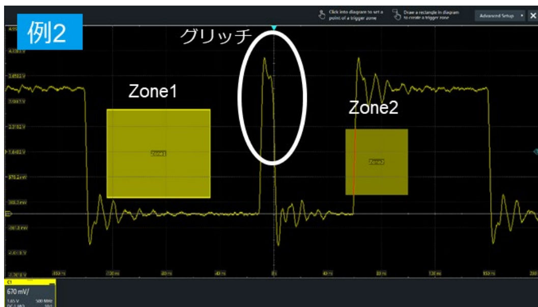
図 23 ゾーントリガの測定例 2
