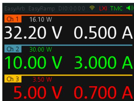
Los distintos estados de funcionamiento se indican mediante colores (ejemplo: R&S®NGE103B).
