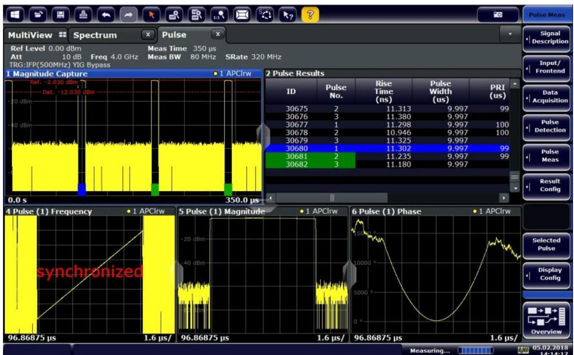
Таким образом многофункциональный генератор может быть использован для создания импульсов с нарастающей ЛЧМ. Импульсы со спадающей ЛЧМ могут быть реализованы аналогичным способом.
