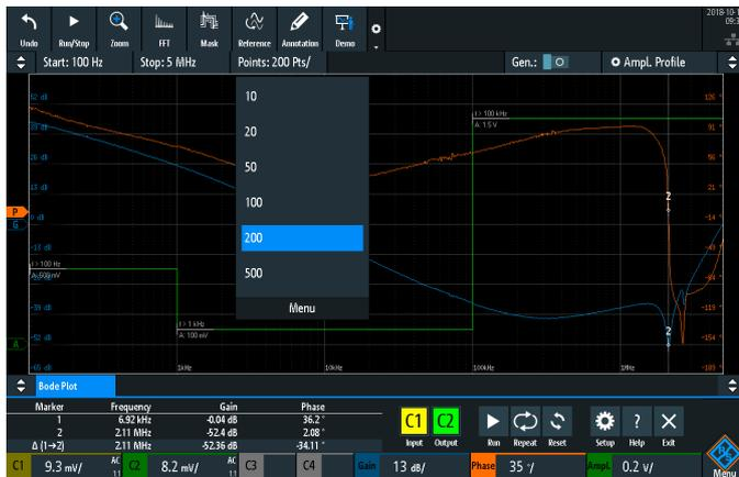
Un tableau de résultats de mesure fournit des informations détaillées sur chaque point mesuré, comprenant la fréquence, le gain et le déplacement de phase
