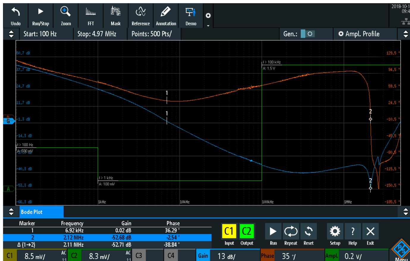
Pour éliminer le comportement parasite (bruit) du dispositif sous test, vous pouvez faire varier le niveau de sortie en amplitude du signal de générateur pendant la mesure
