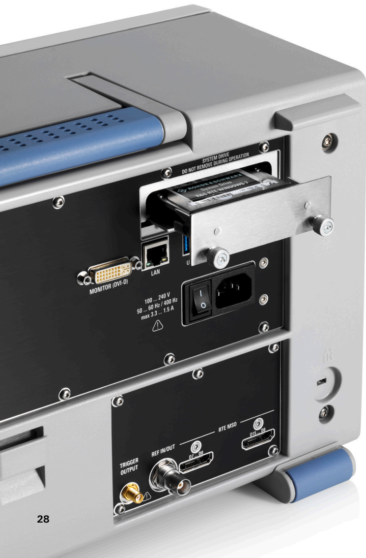
Werkzeugloser Ausbau der Festplatte im R&S®RTE Oszilloskop.
