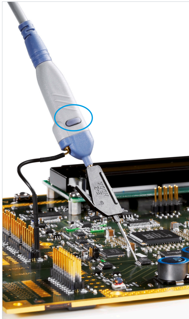
実用的なデザイン：マイクロボタンによる便利な測定器制御。さまざまな種類のプローブチップとグランドケーブルが、標準アクセサリとして付属しています。
