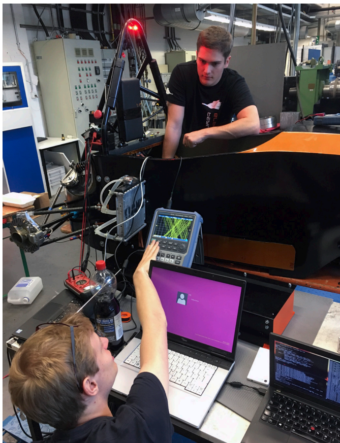
Рисунок 3 — При передаче данных по шине CAN отсутствие нагрузочного сопротивления привело к сбою сигнала в шине. Источник: гоночная команда Elefant
