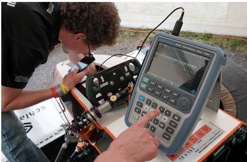
Рисунок 4 — Отладка систем на обочине трассы с помощью опции запуска и декодирования для сигналов шины CAN. Источник: гоночная команда Elephant
