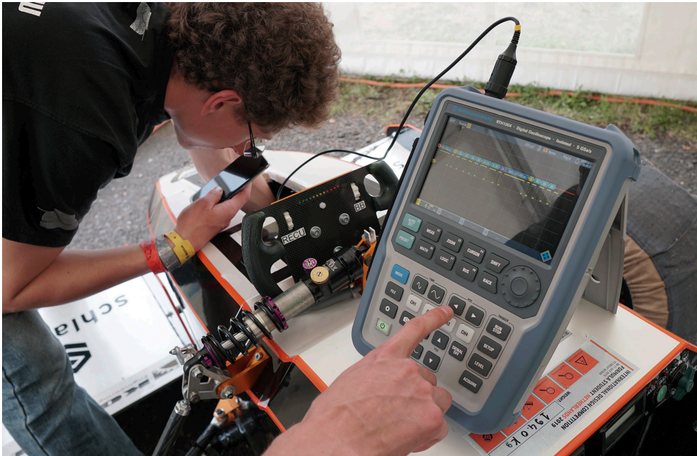
Bild 4: Fehlersuche am Streckenrand mit der Trigger- und Decoder-Option für CAN-Bussignale. Quelle: Elefant Racing Team
