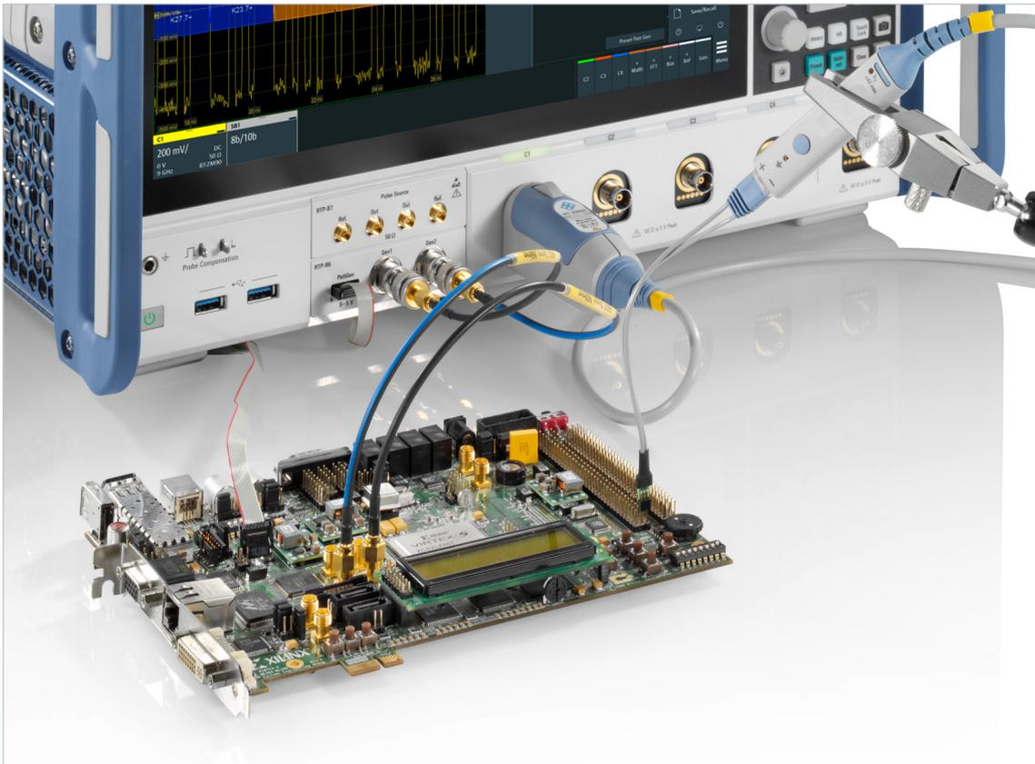
기기의 프로그래밍 및 컨트롤을 위해 통합 임의 파형 발생기(클록 신호로 사용)와 8비트 패턴 발생기를 사용하여 LVDS 신호 측정
