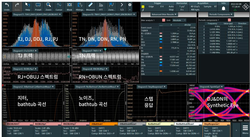
8 Gbps PCIe Gen3 신호의 히스토그램, 스펙트럼, Synthetic EYE 및 BER bathtub 곡선에 스텝 응답, 개별 지터 및 노이즈 성분을 표시합니다.
