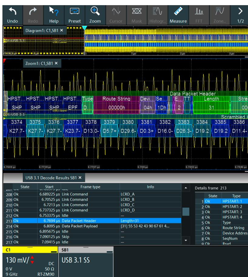
在波形显示界面和解码表中清晰显示解码数据
