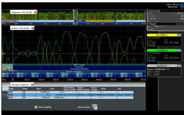
バス信号の具体的なデバッグが行なえます。バス上でどのような問題が発生しているのかを確認し、トリガによりフレーム・アドレスまたはバス・エラーで発生する不具合信号を捕捉します。デコードは、スクランブルまたはデスクランブルされた状態、または3値信号として示すことができます。
