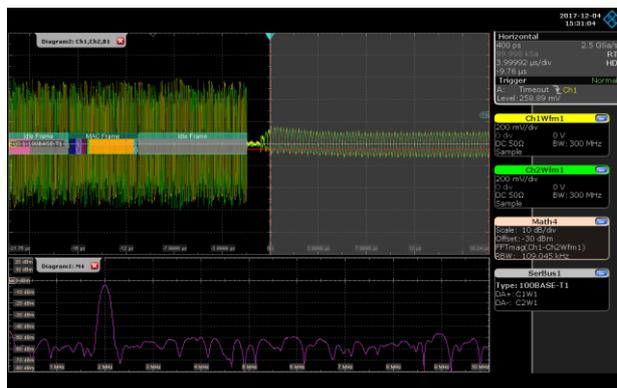
プロトコルのデコードを他の分析ツールと組み合わせることができます。ここでは信号が途切れる直前まで正常にデータ通信しています。ブレークダウンの理由は、画面下部のFFTに見られる2 MHzの信号によるものです。
