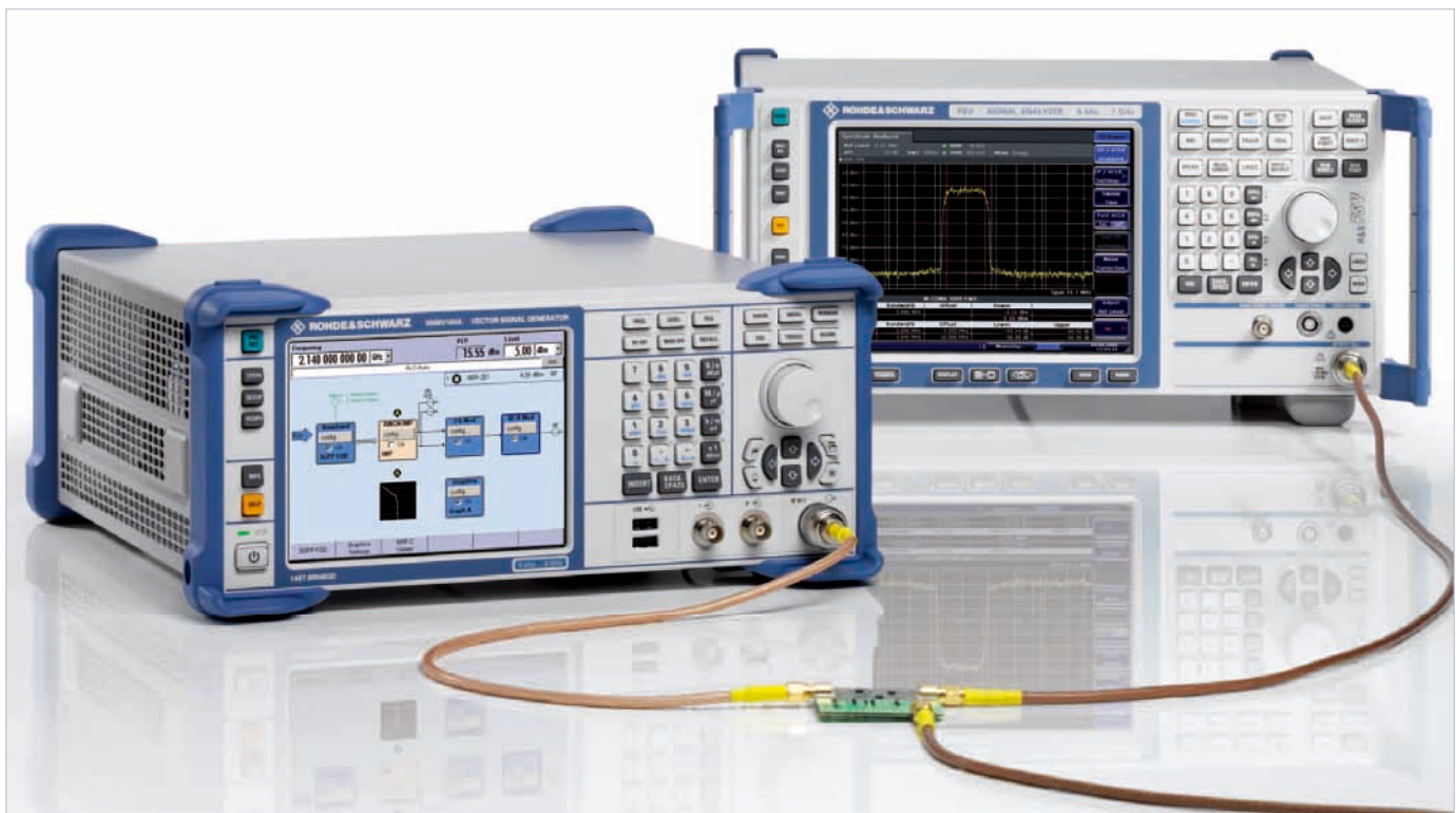
R&S®SMBV100A とR&S®FSV : デジタル変調信号の生成と解析に
