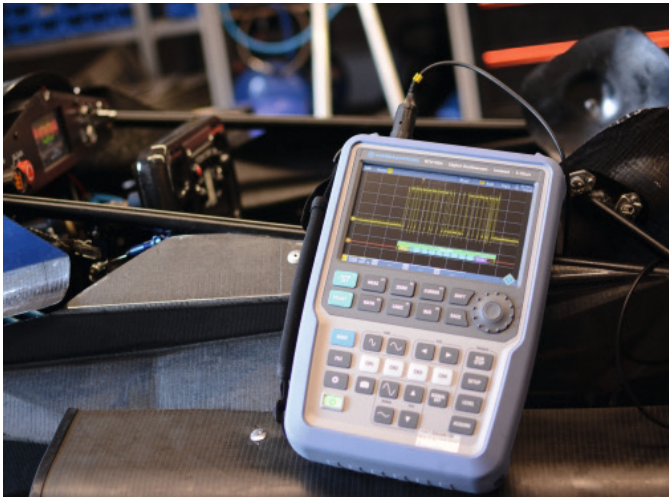
Niklas Waldstein misst an der Motorsteuerung des F17, um die Zündunterbrechung zu testen.
