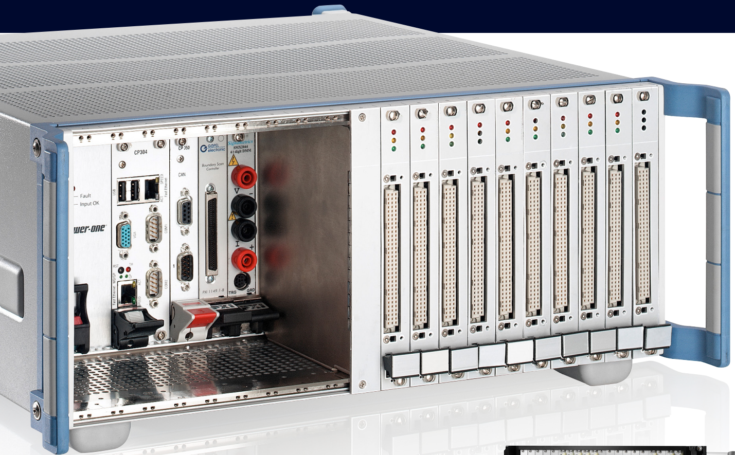
R&S®CompactTSVP搭载Virginia Panel Corporation提供的专用批量互连接口
