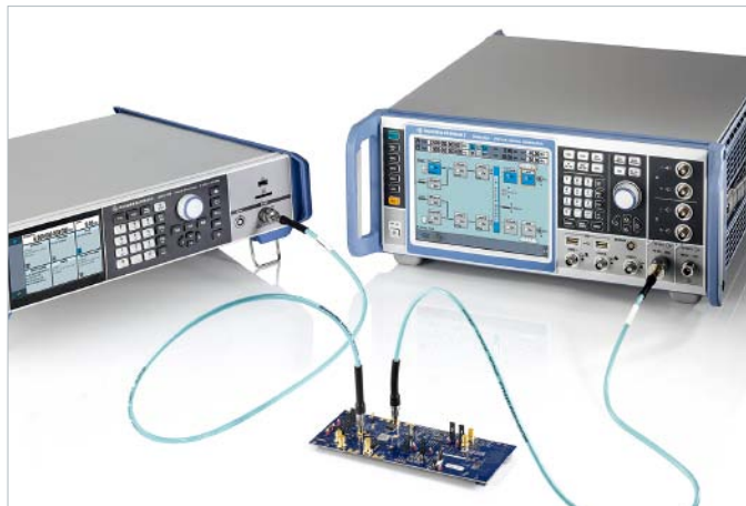
将数字信号馈送至时钟信号旁的ADC模拟输入。
