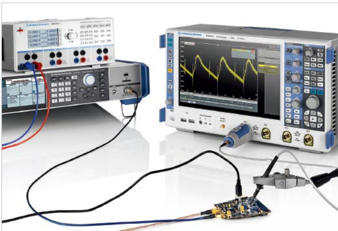
采用电源轨探针和示波器的电源完整性测量设置。
