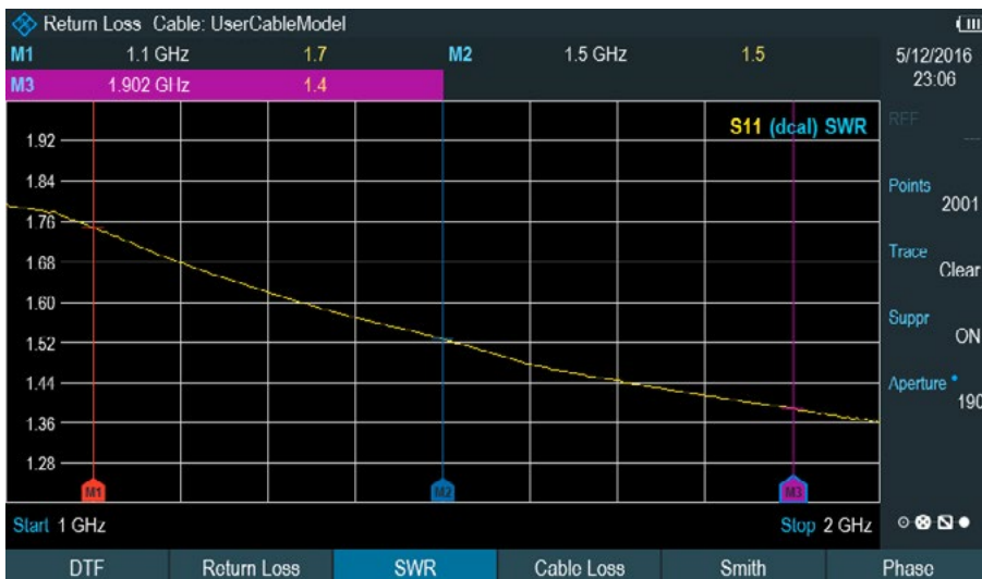
Messung des Stehwellenverhältnisses (VSWR)
