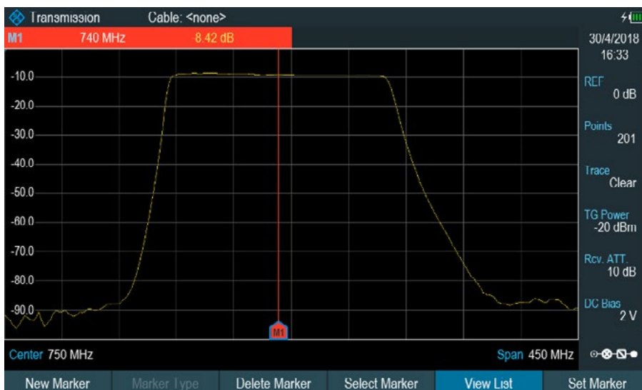
使用 R&S®ZPH-K1 選配進行濾波器傳輸量測
