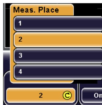
3. Knopf 'Navigation' drücken, um das Auswahlmenü sofort zu schließen. Andernfalls wird das Auswahlmenü nach Ablauf der Menu Off-Zeit automatisch geschlossen "Menu Off" ("Setup" -Menü).
