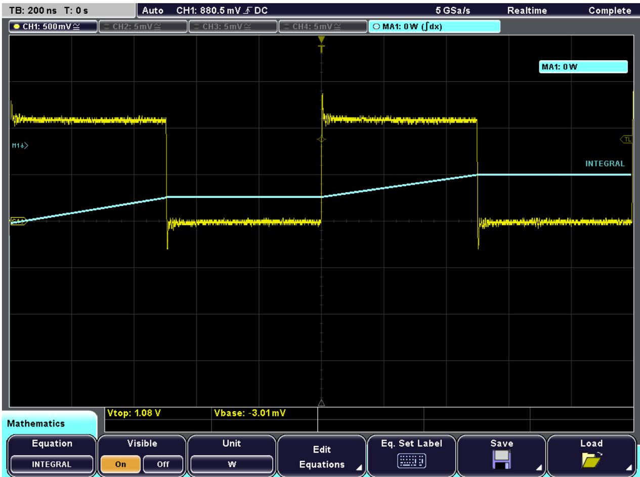
11. Zum Anzeigen des Integrals eines einzelnen Pulses einen V-Marker-Cursor konfigurieren, dessen Quelle die erste mathematische Messkurve ist ("MA1" oder "Integral") und die Cursor am Anfang und Ende des Pulses positionieren. Eine Beschreibung hierzu finden Sie im vorangegangenen Beispiel, [Kapitel 4.4, "Cursor-Messungen durchführen"](#), auf Seite 31.
