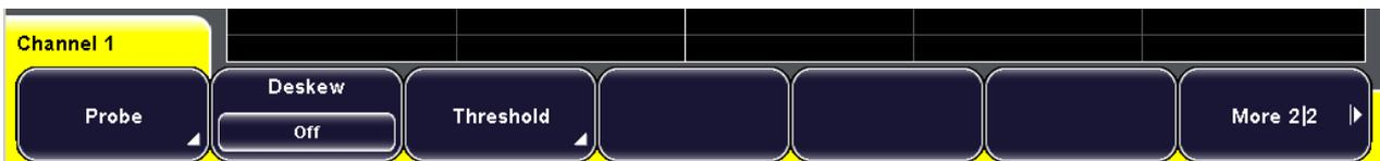
**Bild 5-2: Menüs: Mit "Probe" und "Threshold" werden Untermenüs geöffnet, "More" schaltet die Menüseiten um**
