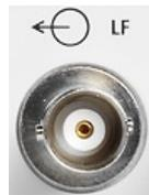
Ausgang für internes LF-Modulations-Generatorsignal.
