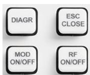
Diese Tasten ordnen verschiedene Fenster auf dem Bildschirm an und schalten das RF-Signal und die Modulation ein und aus.
