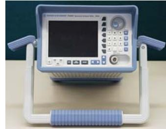
2. Verstellen Sie den Handgriff stufenlos in Längsrichtung und stufenweise (ca. 12°) in radialer Richtung.
