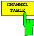
Der Softkey *CHANNEL TABLE* selektiert die Auswertung Kanalbelegungstabelle, bei der alle aktiven Kanäle dargestellt werden.
