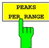
Der Softkey *PEAKS PER RANGE* definiert, wie viele Spitzenwerte innerhalb eines Bereiches gesucht werden. Die Bereiche sind gemäß der Einstellung der Band Klasse (EINSTELLUNGEN -> BAND KLASSE) z.B. für BAND KLASSE 0, 2, 3, 5, 9, 10, 11 und 12:
