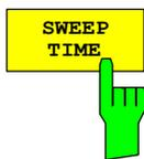
Der Softkey *SWEEP TIME* aktiviert die Eingabe der Sweepzeit. Mit dem RMS-Detektor führt eine längere Sweepzeit zu stabileren Messergebnissen.
