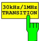
Der Softkey *30kHz/1MHz TRANSITION* bestimmt die Offset Frequenz bei der die Auflösebandbreite zwischen 30 kHz und 1 MHz umgeschaltet wird.
