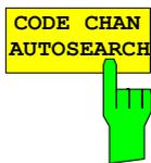
Der Softkey *CODE CHAN AUTOSEARCH* ermöglicht Messungen des Code-Domain-Power-Analysators im automatischen Suchmodus. In diesem Modus werden alle Kanaltypen entsprechend ihrer Spreading-Faktoren nach aktiven Kanälen durchsucht. Ein Kanal ist dann aktiv, wenn die vom Benutzer eingegebene Mindestleistung im Bezug auf die Gesamtleistung überschritten wird (siehe *Softkey INACT CHAN THRESHOLD*).
