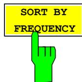
Der Softkey *SORT BY FREQUENCY* sortiert die Liste in aufsteigender Reihenfolge gemäß der Spalte *FREQUENCY*.
