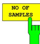
Der Softkey *NO OF SAMPLES* stellt die Anzahl der Leistungsmesswerte ein, die für die Verteilungsmessfunktion zu berücksichtigen sind.
