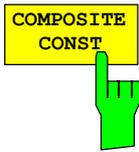
Der Softkey *COMPOSITE CONST* selektiert die Auswertung des Konstellations–Diagramms auf Chip–Ebene.
