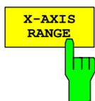
Der Softkey *X-AXIS RANGE* ändert den Pegelbereich, der von der gewählten Verteilungsmessfunktion zu erfassen ist. Die Funktion ist identisch mit der des Softkeys *RANGE LOG MANUAL* im Menü *AMPT*.
