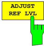
Der Softkey *ADJUST REF LVL* passt den Referenzpegel des Analysators an die gemessene Kanalleistung an. Damit wird sichergestellt, daß die Einstellungen der HF-Dämpfung und des Referenzpegels optimal an den Signalpegel angepasst werden, ohne daß der Analysator übersteuert wird oder die Dynamik durch zu geringen Signal-Rauschabstand eingeschränkt wird.
