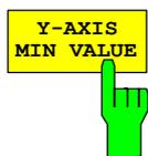
Der Softkey *Y-AXIS MIN VALUE* legt die untere Grenze des dargestellten Wahrscheinlichkeitsbereichs fest. Da die Y-Achse logarithmisch skaliert ist, muss der Abstand zwischen Maximal- und Minimalwert mindestens eine Dekade betragen. Zulässiger Wertebereich  $0 < \text{Wert} < 1$ .
