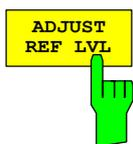
Der Softkey *ADJUST REF LVL* passt den Referenzpegel des Analysators an die gemessene Gesamtleistung des Signals an.
