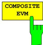
Der Softkey *COMPOSITE EVM* wählt die Auswertung der Error-Vector-Magnitude (EVM) über das Gesamtsignal (Modulation Accuracy).
