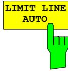
Der Softkey *LIMIT LINE AUTO* wählt die zu überprüfende Grenzwertlinie automatisch nach Bestimmung der Leistung im Nutzkanal aus. Wird die Messung im *CONTINUOUS SWEEP* betrieben und ändert sich die Kanalleistung von Sweep zu Sweep, kann das in einer fortlaufenden Neuzeichnung der Grenzwertlinie resultieren.
