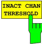
Der Softkey *INACT CHAN THRESHOLD* erlaubt die Eingabe der minimalen Leistung, die ein Einzelkanal im Kanaltyp MAC oder DATA im Vergleich zum Gesamtsignal des Kanaltyps haben muss, um als aktiver Kanal angesehen zu werden.
