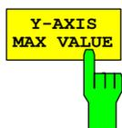
Der Softkey *Y-AXIS MAX VALUE* legt die obere Grenze des dargestellten Wahrscheinlichkeitsbereichs fest. Die Werte auf der Y-Achse sind normalisiert, d.h. der Maximalwert ist 1.0. Da die Y-Achse logarithmisch skaliert ist, muss der Abstand zwischen Maximal- und Minimalwert mindestens eine Dekade betragen.
