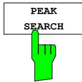
Der Softkey *PEAK SEARCH* aktiviert eine einzige Auswertung der Spectrum Emission Mask. Die Grenzwertmaske - reduziert durch einen Sicherheitsabstand - wird gegen die Trace geprüft. Die Fail-Positionen werden durch Kreuze markiert, solange kein weiterer Sweep durchgeführt wird. Es wird empfohlen, Single Sweep zu benutzen. Jeder Wert wird einer Spitzenwertliste hinzugefügt, die geöffnet sowie im ASCII-Format gespeichert oder über einen IEC-Bus-Befehl ausgelesen werden kann.
