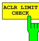
Softkey *ACLR LIMIT CHECK* schaltet die Grenzwertüberprüfung der ACLR-Messung ein bzw. aus.
