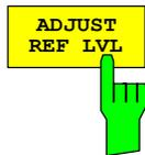
Der Softkey *ADJUST REF LVL* paßt den Referenzpegel des Gerätes an die gemessene Kanalleistung an. Damit wird sichergestellt, daß die Einstellungen der HF-Dämpfung und des Referenzpegels optimal an den Signalpegel angepaßt werden, ohne daß der Analysator übersteuert oder die Dynamik durch zu geringen Signal-Rauschabstand eingeschränkt wird.
