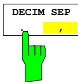
Unterschiedliche Sprachversionen von Auswertprogrammen benötigen u. U. eine unterschiedliche Behandlung des Dezimalpunkts. Aus diesem Grund ist es möglich, zwischen Default-Separatoren '.' (Dezimalpunkt) und ',' (-komma) mithilfe des Softkeys *DECIM SEP* zu wählen.
