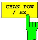
Der Softkey *CHAN POW / HZ* schaltet zwischen der Messung der Gesamtleistung im Kanal und der Messung der Leistung im Kanal bezogen auf 1 Hz Bandbreite um.
