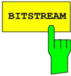
Der Softkey *BITSTREAM* selektiert die Auswertung "Bitstream". Die Auswertung der entschiedenen Bits erfolgt für den gewählten Code (Softkey *SELECT CODE*) im eingestellten Kanaltyp (Softkey *CHAN TYPE*) und den gewählten Slot (Softkey *SELECT SLOT*). Somit berücksichtigt diese Auswertung Ergebnisse eines Codes im gewählten Kanaltyp für einen Slot.
