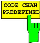
Der Softkey *CODE CHAN PREDEFINED* überführt die CDP-Analyse in den Messmodus unter Zuhilfenahme vordefinierter Kanaltabellen. In diesem Modus wird keine Suche nach aktiven Kanälen durchgeführt, sondern es werden die Kanäle einer vor der Messung definierten Kanaltabelle als aktiv vorausgesetzt.
