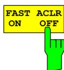
Der Softkey *FAST ACLR* schaltet zwischen der Messung nach der IBW-Methode (*FAST ACLR OFF*) und der Messung im Zeitbereich (*FAST ACLR ON*) um.
