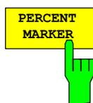
Bei aktiver *CCDF*-Funktion erlaubt der Softkey *PERCENT MARKER* die Positionierung von Marker 1 durch Eingabe einer gesuchten Wahrscheinlichkeit. Damit läßt sich auf einfache Weise die Leistung ermitteln, die mit einer vorgegebenen Wahrscheinlichkeit überschritten wird.
