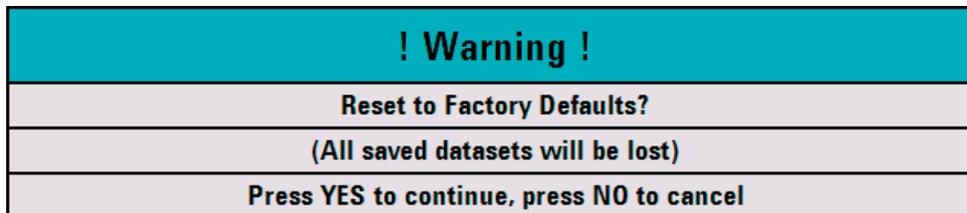
Para iniciar el procedimiento de restauración, pulse la tecla de función "Sí" ("Yes"). El firmware reinicia el R&S FSC y restaura todos los ajustes. Durante el proceso muestra un mensaje.
