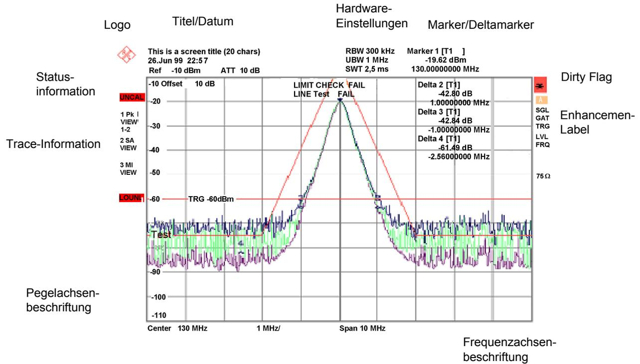
Fig. 4-1 Bildschirmaufteilung des R&S FSG im Analysatorbetrieb
