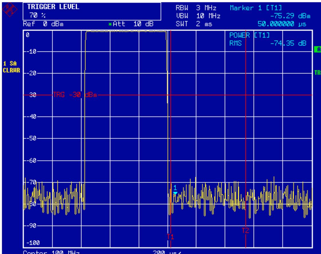
Fig. 5-15 Messung des Signal-/Rauschverhältnisses eines GSM-Burst-Signals im Zeitbereich
