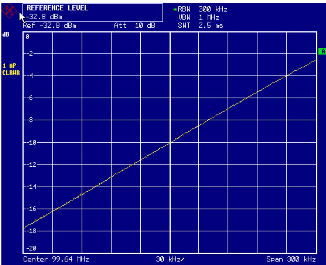
Fig. 5-17 Darstellung der Filterflanke des  $300$ -kHz-Filters als FM-Diskriminatorkennlinie.
