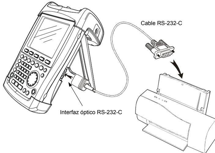
Conectar las impresoras con interfaz paralelo al R&S FSH usando el convertidor serie / paralelo R&S FSH-Z22. El R&S FSH-Z22 se alimenta mediante una batería alcalina de 9 V (NEDA, IEC6LR61).
