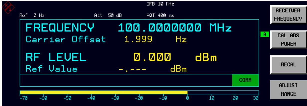
Bild 4.11 Korrigierte Anzeige nach Durchführung von CAL ABS POWER
