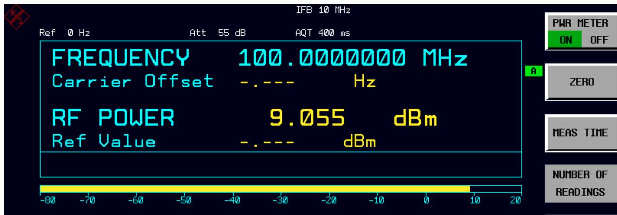
Bild 4.16 RF POWER Anzeige mit Leistungsmesser
