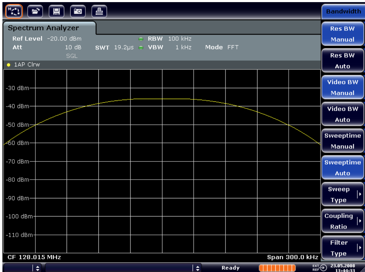
Bild 6-5: Messung von zwei HF-Sinussignalen gleichen Pegels mit einer Auflösungsbandbreite, die größer ist als der Frequenzabstand der Signale
