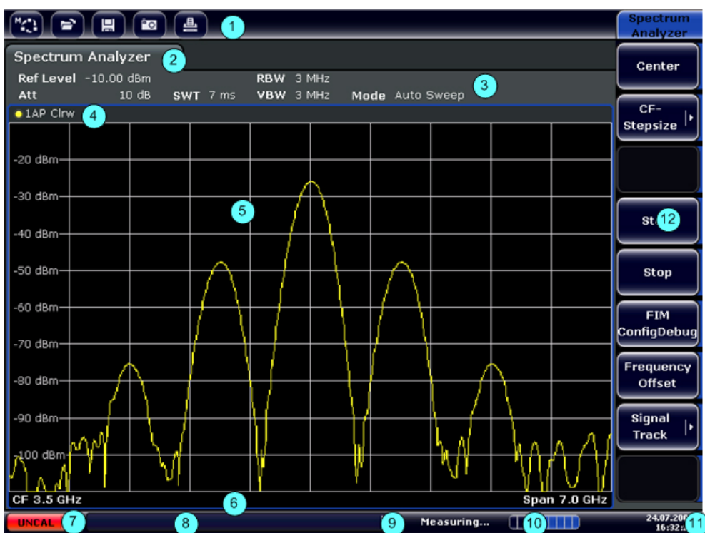
图 5-1: 分析仪操作过程中 R&S FSVA/FSV 的屏幕布局
